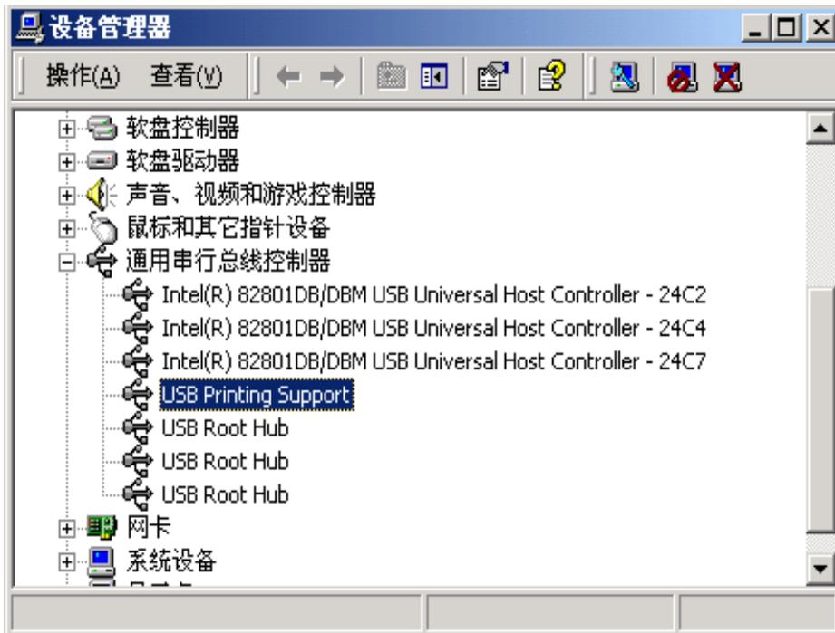
则表明此USB端口打印机已正常与计算机连接，可以通过USB端口与打印机通讯。
