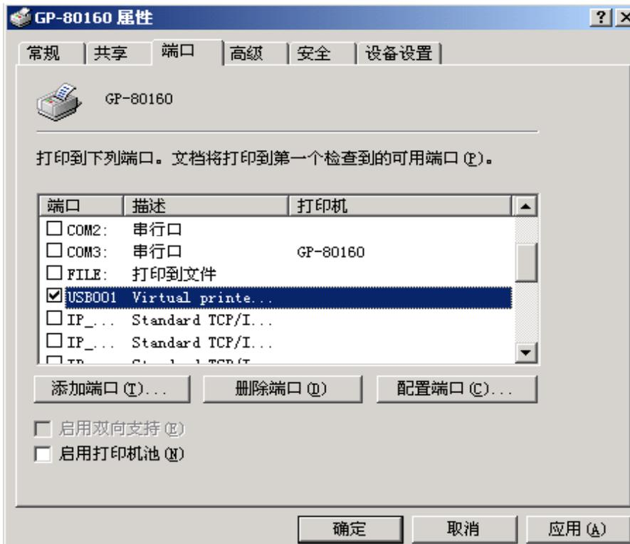
3、执行打印测试页，查看打印是否正常。正常则表明打印机已与计算机正确连接且通讯正常。
