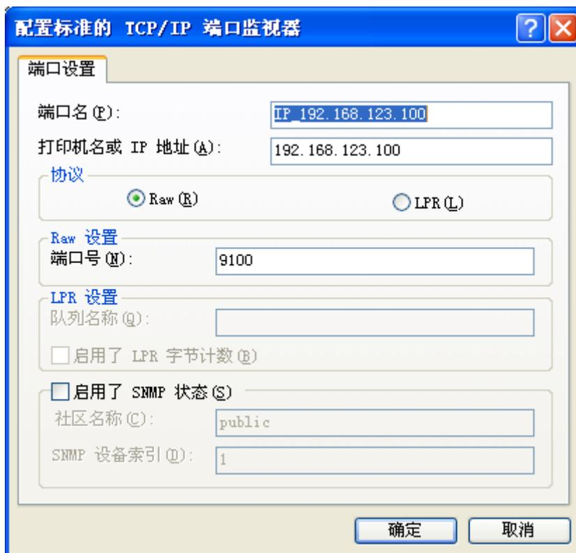
依照所连接的以太网接口打印机设置如上图所示的 IP 地址端口名，其中“协议”项选择“Raw”，“Raw 设置”项“端口号”为“9100”，最后“确定”即可在 PC 机上创建打印机以太网通讯端口“IP\_192.168.123.100”。
